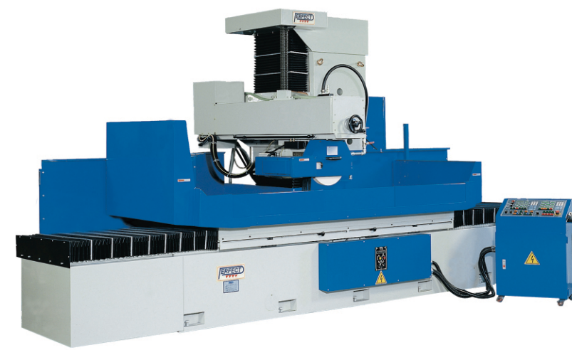
PFG-100200AHD 1000x2000mm 전지척 크기 NC 자동 두상 드레싱 장치와 자동 보정 시스템 • 전후 속도는 유압 밸브 변화량에 따른 무단 연속 • 전후 자동 이송 • 상하 이송은 AC 서보 모터 이송 방식 • NC 자동 하강 이송 시스템
